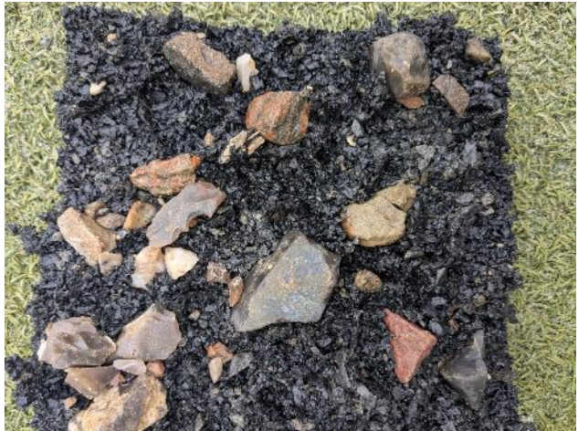
Abb. 8: Anhaftungen Schotter an Unterseite ET MP 2
